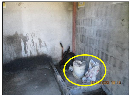
ภาพถ่ายที่ 2.2-29 ทราย์สำหรับดูดซับน้ำมันบริเวณพื้นที่จัดเก็บ น้ำมันใช้แล้ว อาคารซ่อมบำรุง
